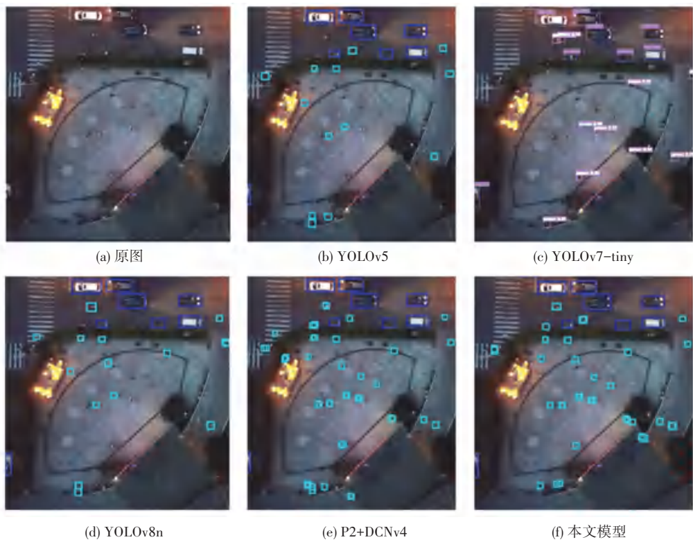
图 6 不同模型在小目标(行人)上的检测性能 Fig. 6 Detection performance of different models on small targets (pedestrians)
