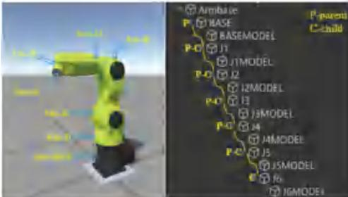
图 6 机械臂模型及其父子层级关系
