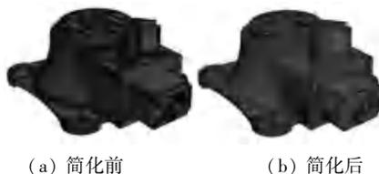
图4 机械臂基座简化前后对比
