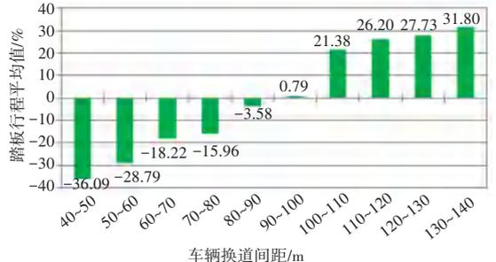
图 5 不同车辆换道间距的换道起始时刻后车踏板行程平均值分布图
